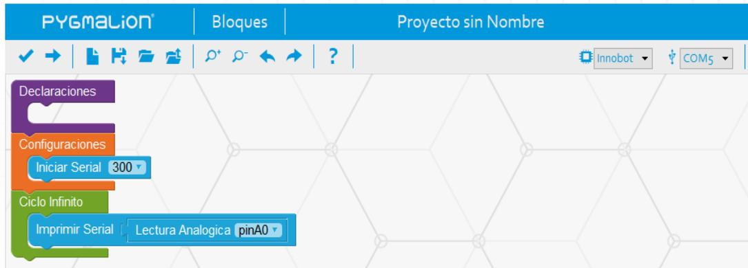
NOTA: Para poder observar los valores debemos tener conectada la tarjeta innobot con el cable de comunicación con el pc, en la foto podemos observar que nos aparece COM5 esto quiere decir que el pc nos reconoció la tarjeta innobot y están conectados.
